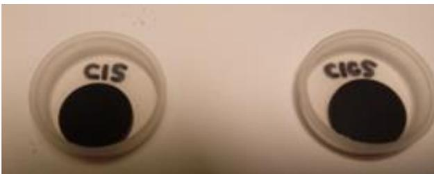
2) Target di CIGSS con diversi rapporti (In/Ga e S/Se) di 1" e 2" di diametro ad alta densità; confronto con target commerciali (prototipo). DISPONIBILE
