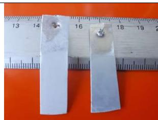
Figura 1: a) Attività catalitica delle schiume preparate; b) Risultati preliminari del pretrattamento di supporti in alluminio (deposizione di uno strato di  $Al_2O_3$  tramite anodizzazione).
