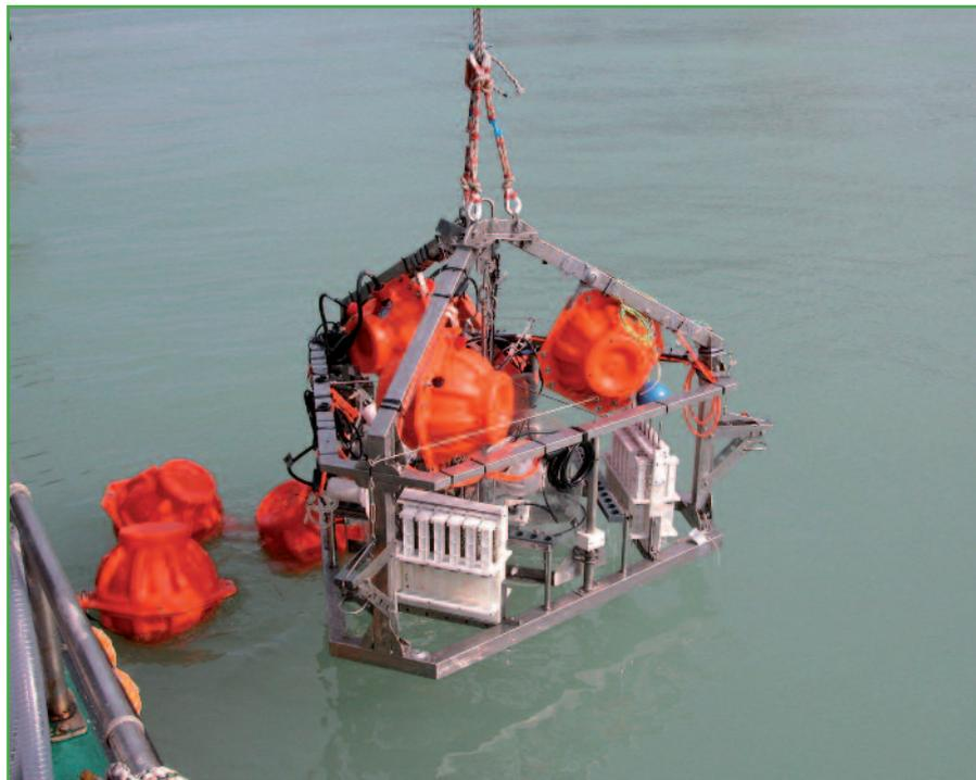
> Lander benthico autonomo e automatico AMERIGO completo di strumentazione di prelievo e analisi
