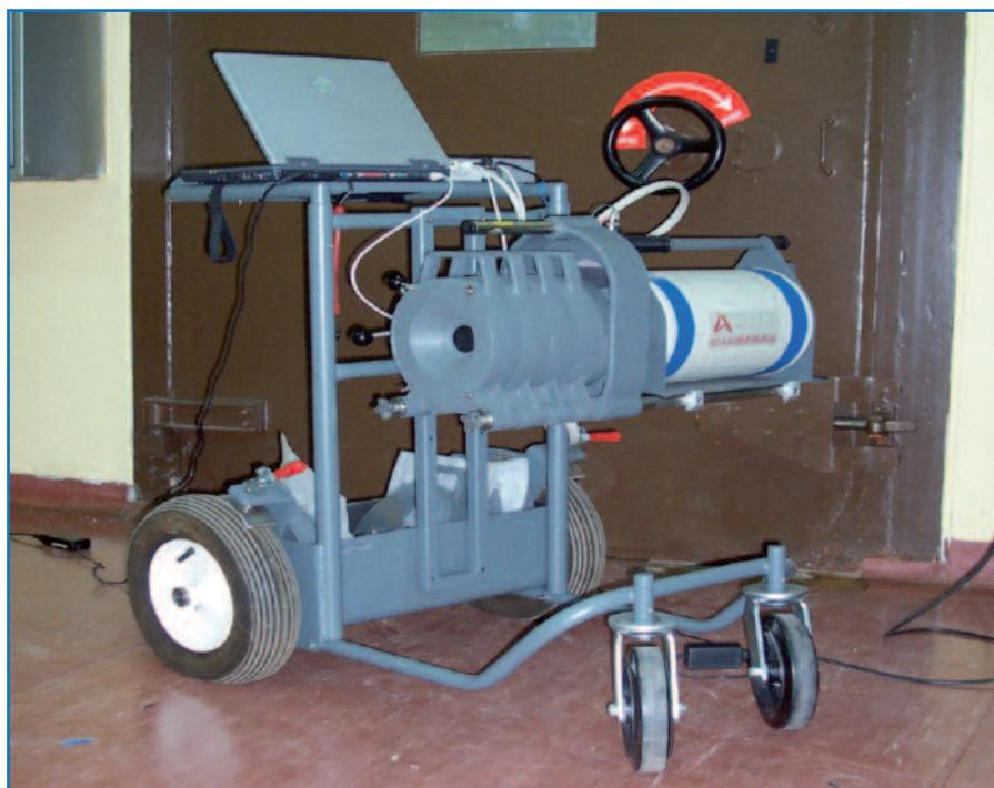
> Strumento portatile per misura gamma
