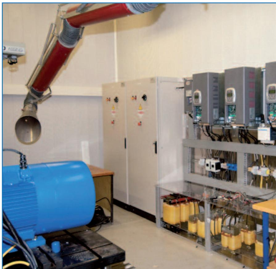
> Prototipo di impianto di sollevamento con recupero di energia tramite supercondensatori - ENEA
