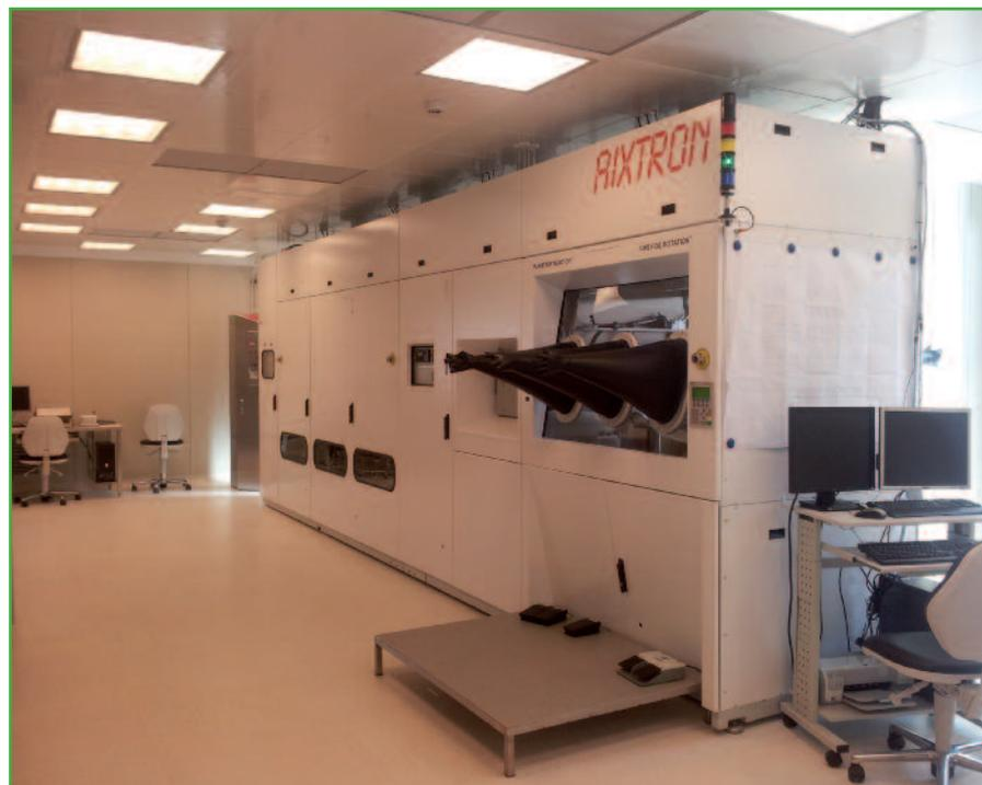
> Reattore MOCVD per la realizzazione delle celle multigiunzione
