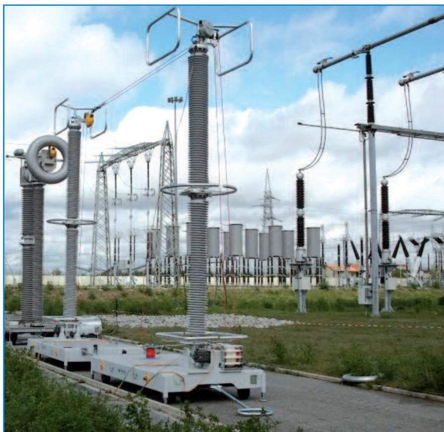
> Sistema per la verifica in campo dei trasformatori di tensione di alta tensione (RSE)
