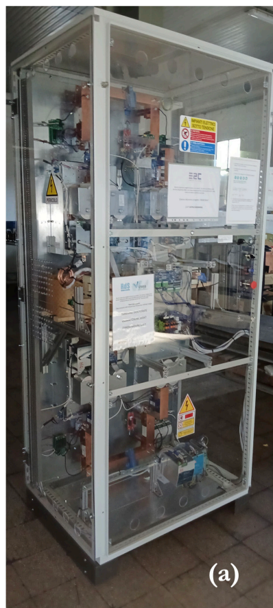
(a) Prototipo del convertitore DAB. (b) Stazione di avvolgimento del nucleo in ferro amorfo. (c) Stazione di collaudo del trasformatore.
