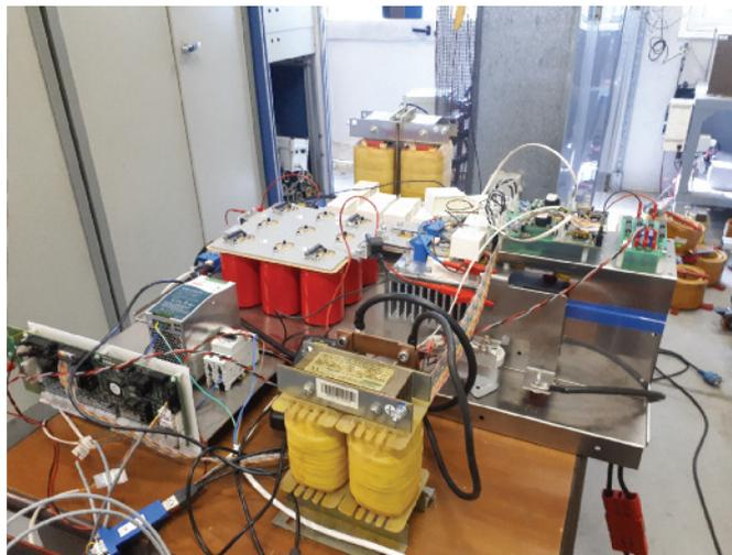
> Prototipo di interruttore monodirezionale in grado di aprire in cortocircuito
