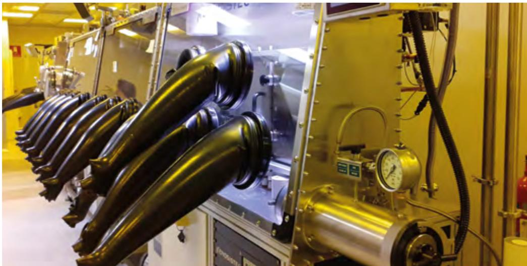
Sistema PECVD utilizzato per la deposizione delle celle solari ad eterogiunzione di silicio installato nelle camere bianche del CR ENEA di Portici.
