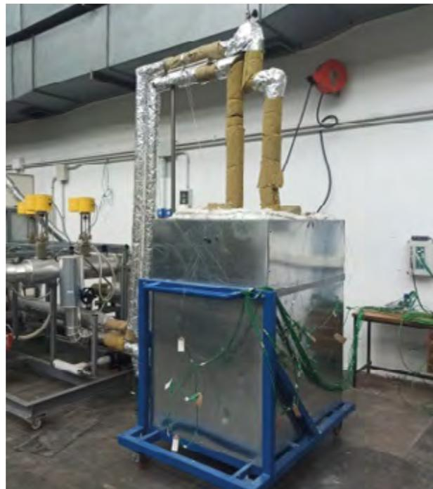
Reattore planare a membrana per la produzione di idrogeno da biogas (WP3).
