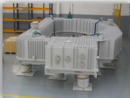
Camera da vuoto per prove finali della bobina toroidale
