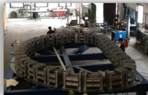
Stampo di impregnazione della bobina toroidale
