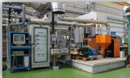
Apparato sperimentale sistemi catalitici per il trattamento dei fumi della combustione di biomasse
