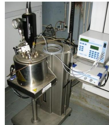
Apparato sperimentale per trattamenti idrotermici di biomasse
