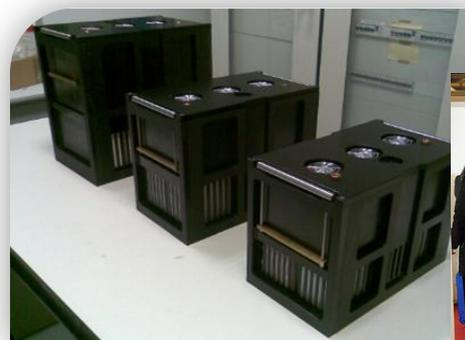
Moduli da 12 V, realizzati con batterie al LiFePO<sub>4</sub>
