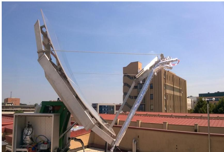
Impianti di conversione - Collettore solare a concentrazione lineare
